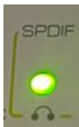
Rysunek 4. Zielona dioda SPDIF oznacza, że dźwięk powinien być przesyłany z podłączonego urządzenia
